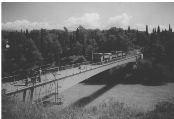
SLIKA 1: Položaj probnog opterećenja u toku ispitivanja konstrukcije
